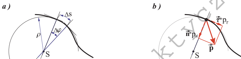
Rysunek 5.11: Okrąg ściśle styczny do toru punktu i promień krzywizny toru \rho (a) oraz składowa styczna i normalna wektora przyspieszenia (b)
