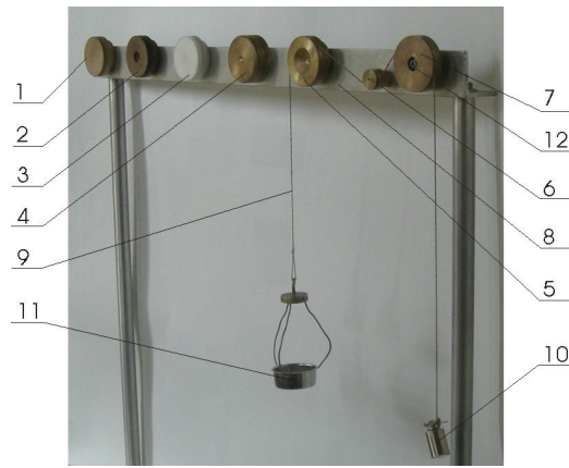
Rysunek 2: Stanowisko do badania tarcia cięgien i momentów oporu
