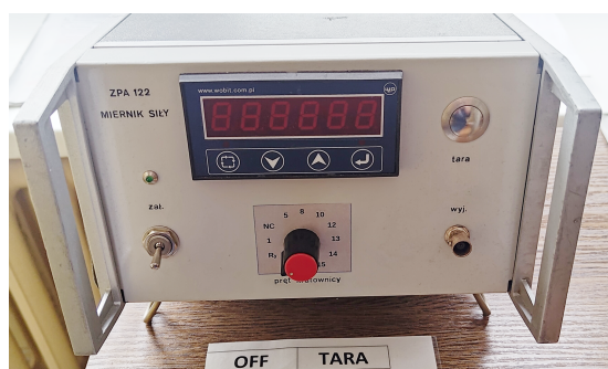
Rysunek 8: Tensometryczny układ pomiarowy ZPA 122 ze stanowiska pomiarowego
