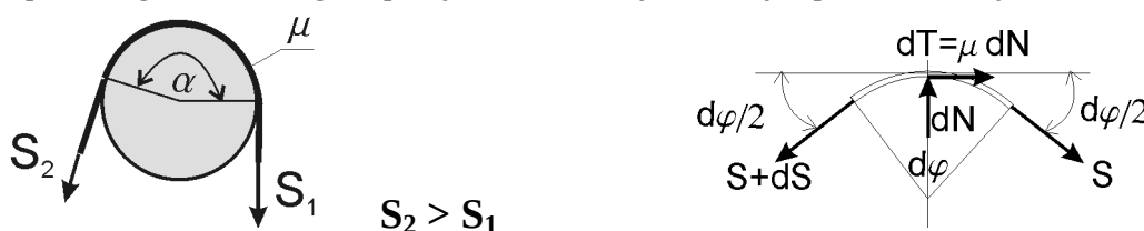
Rys. 1.7. Schemat układu: wiotkie cięgno opasujące krążek
